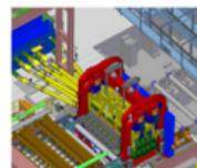
Neue Warmrichtmaschine mit höherer Leistung (bis 4.000 t statt bisher 1.600 t), Blechdicken bis 100 mm und Reduktion Fremdrichten für Gründungselemente in Offshore-Wind
